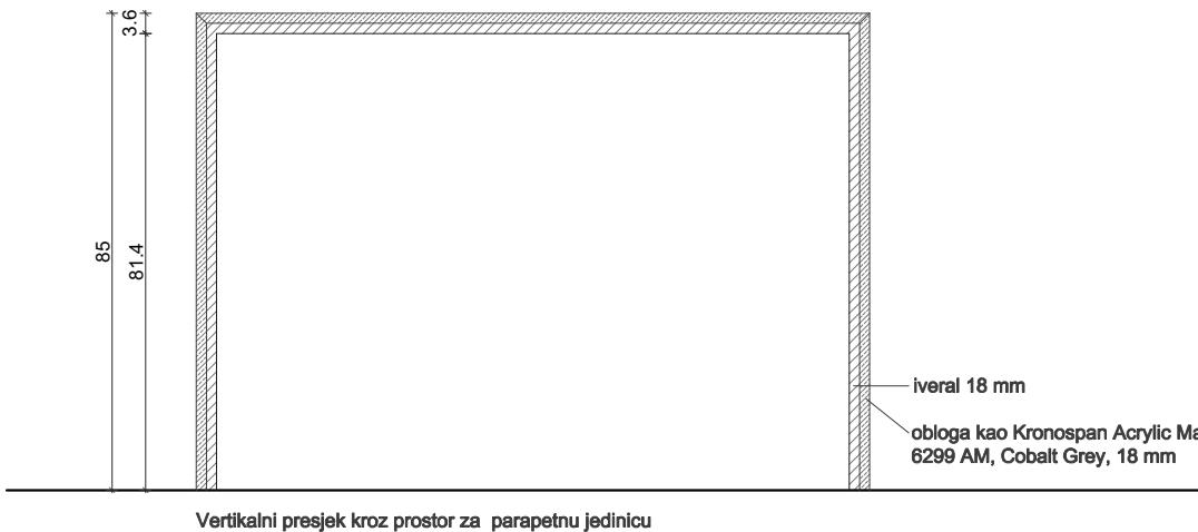
Niski ormarić se sastoji od korpusa koji na prednjoj strani ima police na kojima će se biti prospektni materijal, te prostorom za unutarnju parapetu klima jedinicu, i rešetkom za isput zraka na gornjoj plohi, Konstrukcija postamenta se izvodi od ploča iverala debljine 18 mm, izvana obložene oblogom kao Kronospan Acrylic Matt 6299 AM, Cobalt Grey, debljine 18 mm, osim na stražnjoj strani korpusa, gdje nema obloge.
