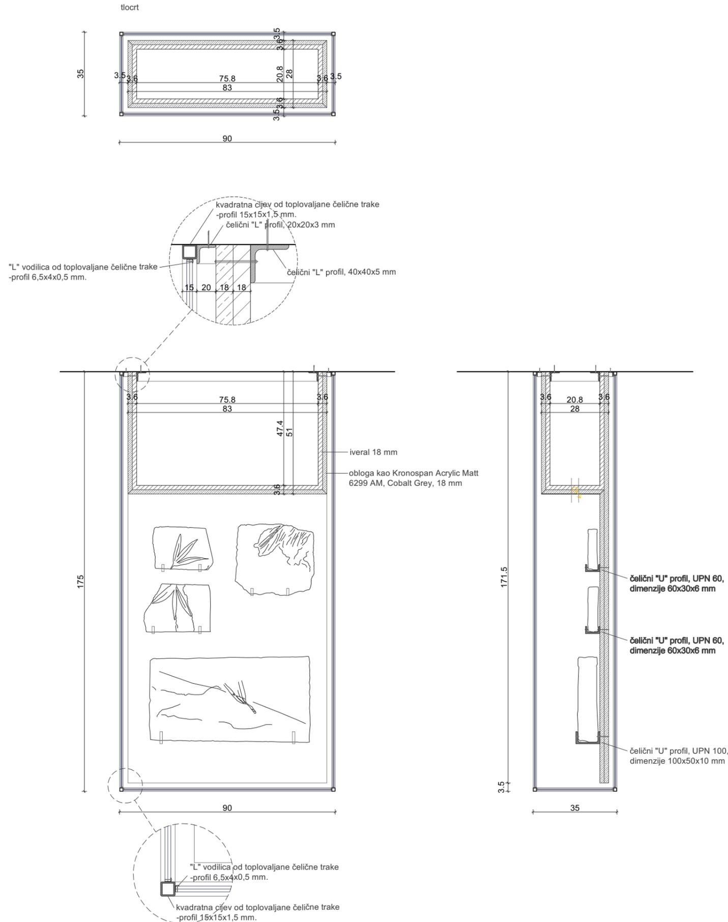
Prvo se u strop montiraju čelični "L" profili 40x40x5 mm. Potom se montira unaprijed pripremljeni drveni sanduk s otvorom prema gore. Sanduk se sastoji od ploča iverala debljine 18 mm, izvana obložene oblogom kao Kronospan Acrylic Matt 6299 AM, Cobalt Grey, debljine 18 mm. Drveni sanduk se vijcima veže za čelične "L" profile.
