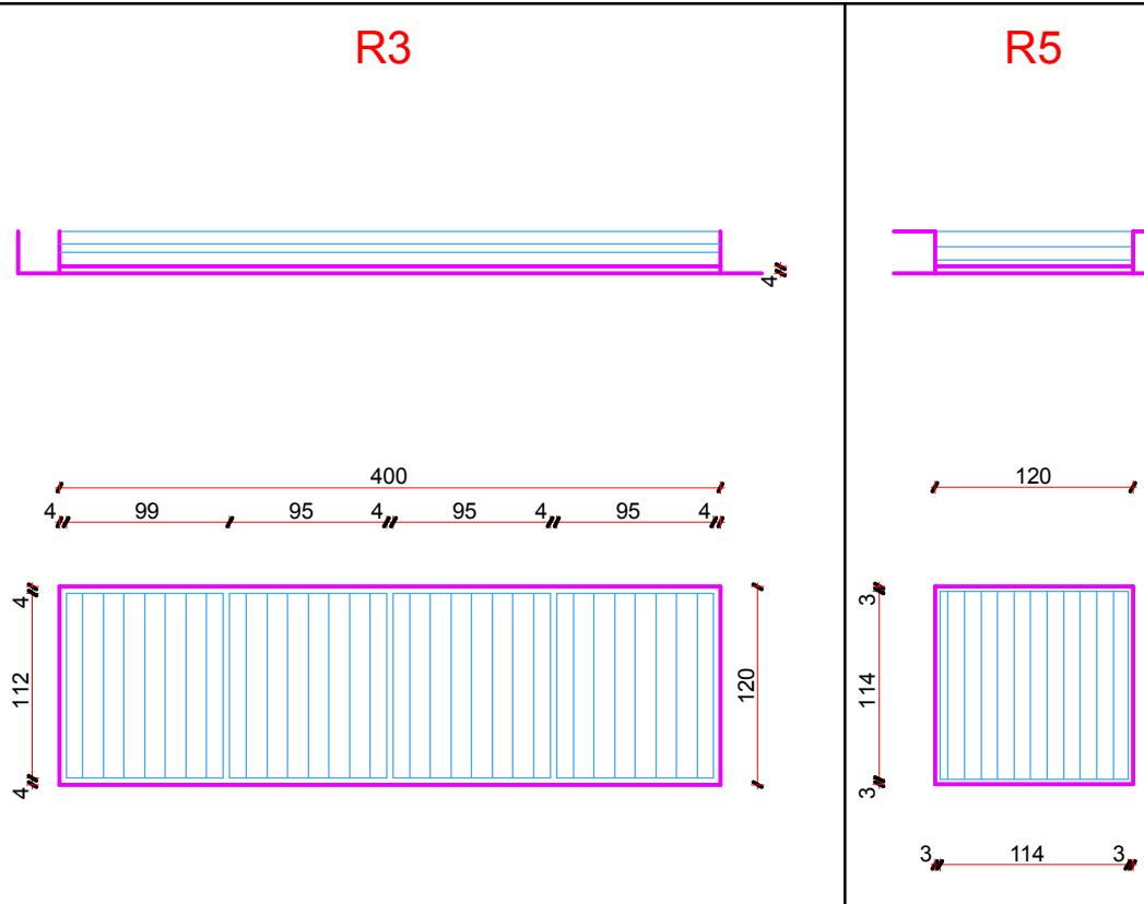
Rešetka je izrađena od čeličnih cilindričnih profila 4x4 cm, debljine stijenke 3 mm kao okvir vrata a ispuna se izvodi od čeličnih okruglih šipki  $\varnothing$  19 mm na osovinskom razmaku od 12,5 cm. Rešetka je podjeljena u četiri polja. Okvir bojati temeljnom bojom i dva puta uljanom lak bojom za željezo u tonu po izboru investitora.
