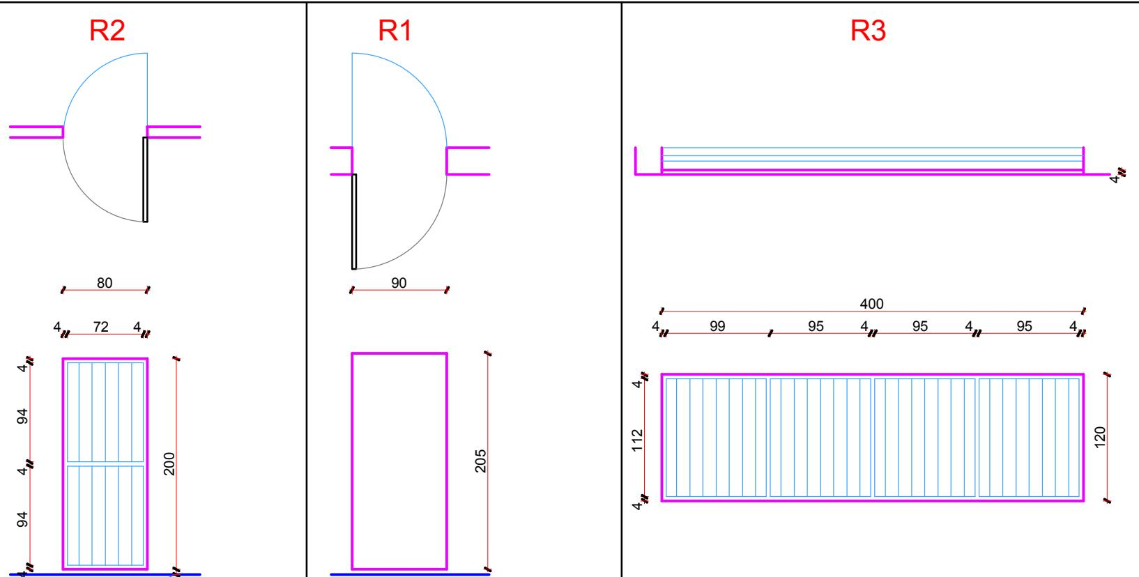
Vrata su izrađena od čeličnih cilindričnih profila 4x4 cm, debljine stijenke 3 mm kao okvir vrata a ispuna se izvodi od čeličnih okruglih šipki  $\varnothing$  19 mm na osovinskom razmaku od 12,5 cm. Vrata su opremljena cilindričnom bravom s tri ključa, ručkama i štitnicima. Vrata bojati temeljnom bojom i dva puta uljanom lak bojom za željezo u tonu po izboru investitora.
